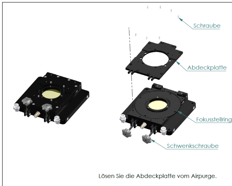
Abbildung 51: Montage des laminaren Freiblasvorsatzes
