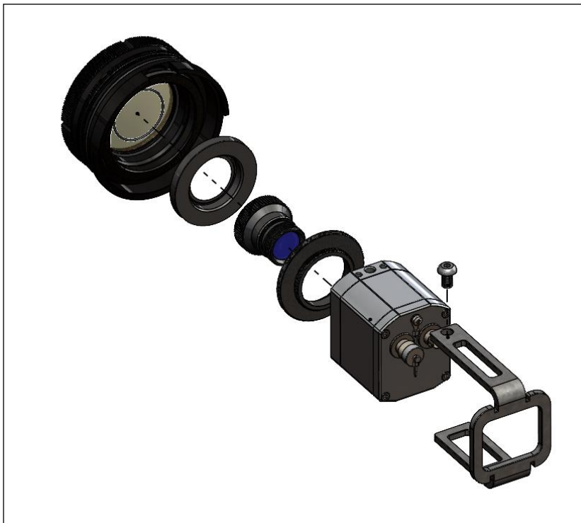
Abbildung 19: Einbau der 80° Optik
